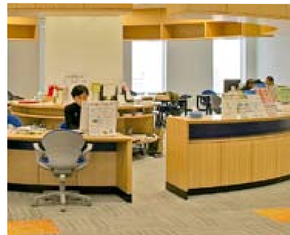
15 専門性をもった市民が図面をチェックして車イスでも使いやすいように高さを抑えた総合案内のカウンター。(p.55,70-71)
